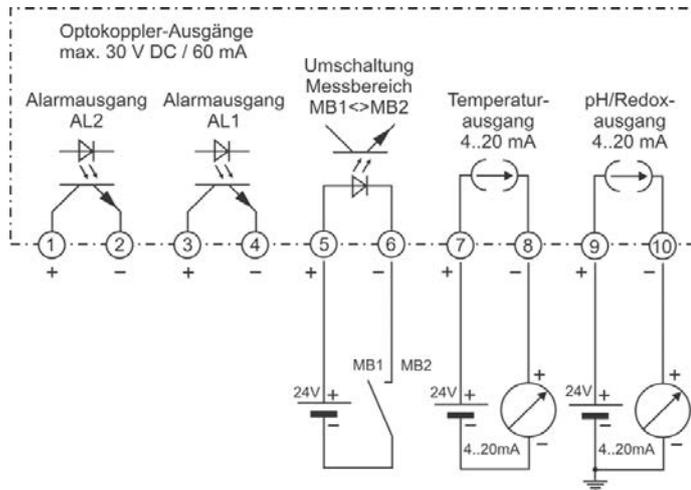
Über die Klemmen 9 und 10 erfolgt die Versorgung des Converters. Bei Verwendung als Anzeigergerät werden die Klemmen 9 und 10 direkt mit der Hilfsspannung verbunden
