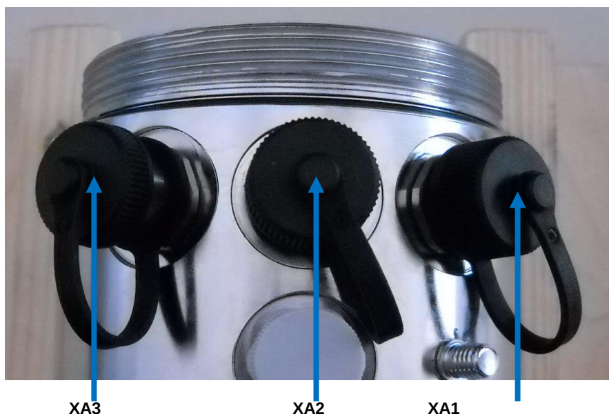
Рис.: Подключение VOLUMTEC PDP через штекерный разъем M12
