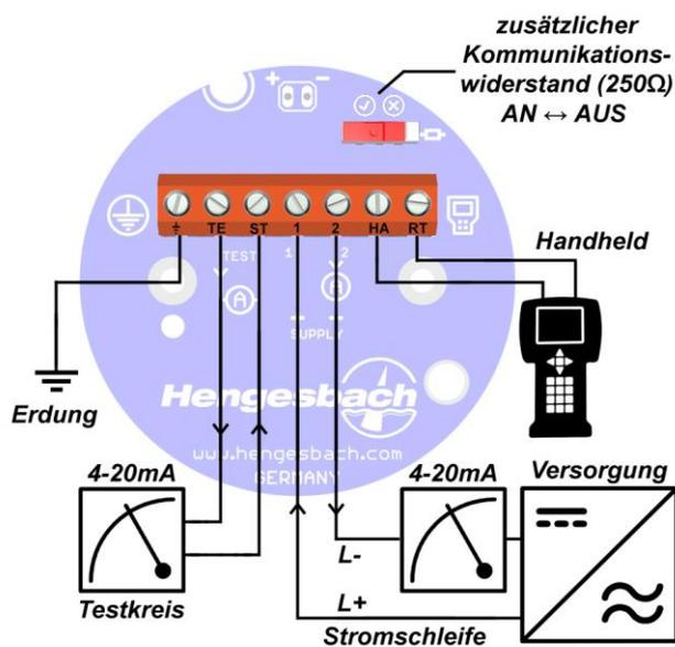
Anschlussschema für ein Gerät der Ausführung 200H/201H
