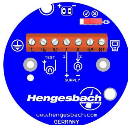
Platine mit den Anschlussklemmen im Kopf des Transmitter-Gehäuses
