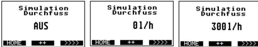
Mit dieser Funktion kann die komplette messtechnische Funktionalität vom VolumMess Umformer simuliert werden, d.h. die Pulsausgänge und der Stromausgang verhalten sich wie im Normalbetrieb. Diese Funktion ist auch zur „trockenen“ Inbetriebnahme einer Anlage bzw. Teilanlagen, geeignet.
