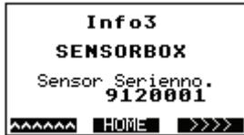
Im Bild Info3 wird angezeigt, ob eine SENSORBOX™ oder MEMBOX™ im Gerät vorhanden ist. In dieser Box sind die Parameter vom Messwertempfänger und spezifische Kundeneinstellungen gespeichert. Bei einem Wechsel des Messwertumformers werden mit dieser Box die Parameter in den neuen Umformer übertragen.
