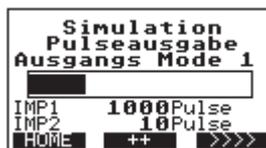
Mit dieser Simulation kann die Verkabelung oder ein Zählinstrument bzw. eine angeschlossene Steuerung überprüft werden. Je nach Ausgangs Mode wird die Anzahl der zu simulierenden Pulse in Zeile 6 und 7 im Display angezeigt. Mit der Taste **++** wird die Simulation gestartet und es wird ein Bargraph angezeigt. Die Simulation ist zu Ende, wenn der Bargraph komplett ausgefüllt ist. Danach wird der Bargraph wieder gelöscht.
