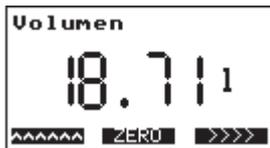
Durch 4 Sekunden langes Bestätigen der Taste **ZERO** wird das Volumen auf 0 gestellt. Die Größe der Ziffern wird durch die Größe des Messwertes gesteuert. Die Volumenanzeige ist das zentrale Bild, das nach einem Reset immer angezeigt wird. Das Volumen wird automatisch zurückgesetzt, wenn der Wert 1.000.000.000 überschreitet oder -100.000.000 unterschreitet.
