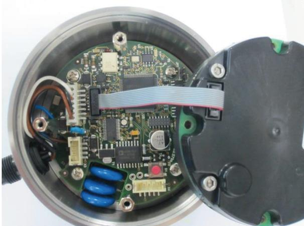
3. Display mit den M3x10 Schrauben befestigen
