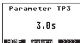
Mit der Taste **ändern** kann die Zeitverzögerung TP3 geändert werden. Mit dieser Zeit wird der Stromausgang gedämpft. Eventuell erfolgt vorher die Aufforderung zur Eingabe des Freischaltcodes.
