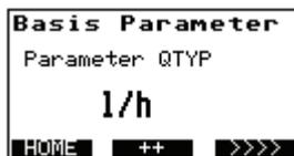
Mit der Taste **++** kann die Maßeinheit für die Durchflussanzeige eingestellt werden. Eventuell erfolgt vorher die Aufforderung zur Eingabe des Freischaltcodes. Es sind zwei Einstellungen möglich, l/h oder l/min.
