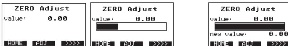
Durch 1.5 s langes Bestätigen der Taste **ADJ** wird die Zero-Adjust-Messung aktiviert. In der oberen Zeile wird der aktuelle Zero-Wert angezeigt. Am Verlauf des Bargraphen erkennt man den Verlauf der Messung. Die Messung ist abgeschlossen, wenn der Bargraph voll ausgefüllt ist. Der neue Zero-Wert wird unter dem Bargraphen angezeigt und übernommen.
