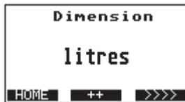
Mit der Taste **++** kann die Dimension vom Messwert gewechselt werden. Eventuell erfolgt vorher die Aufforderung zur Eingabe des Freischaltcodes. Bei einem Wechsel der Dimension wird die Einzel- und Totalmenge auf null zurückgesetzt.
