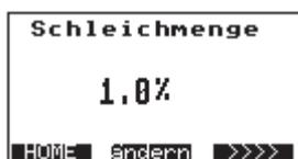
Mit der Taste **ändern** kann die Schleichmenge LFS in % geändert werden. Die Schleichmenge wird von Qmax berechnet. Eventuell erfolgt vorher die Aufforderung zur Eingabe des Freischaltcodes.
