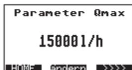
Mit der Taste **ändern** kann der Qmax. für den Stromausgang geändert werden. Qmax ist der Wert für 20 mA. Eventuell erfolgt vorher die Aufforderung zur Eingabe des Freischaltcodes.
