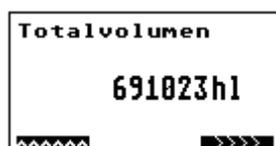
Der Totalzähler zeigt den Betrag der durchgeflossenen Mengen an. Dieser Zähler ist nicht rücksetzbar.
