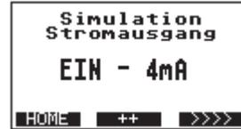
Mit der Simulation kann die Verkabelung überprüft oder z.B. ein analoges Instrument justiert werden.
